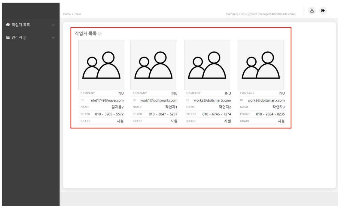
작업자 목록에서 특정 작업자를 선택하는 순간, 본 시스템은 [그림 3-25]와 같이 해당 작업자의 화면 공유 페이지를 제공하게 됩니다. 이 화면 공유 페이지는 현장 작업자의 MRC를 표시하며, 현장 작업자와의 소통을 가능케 하는 전반적인 사용자 인터페이스를 제공합니다.
