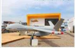
Hermes 900 | <ul style="list-style-type: none"> <li>• 최대 30시간 비행 가능</li> <li>• 최대고도 9,100m 비행</li> <li>• 정찰, 감시 및 통신 임무 수행</li> <li>• 적재 중량은 300kg</li> </ul> |
