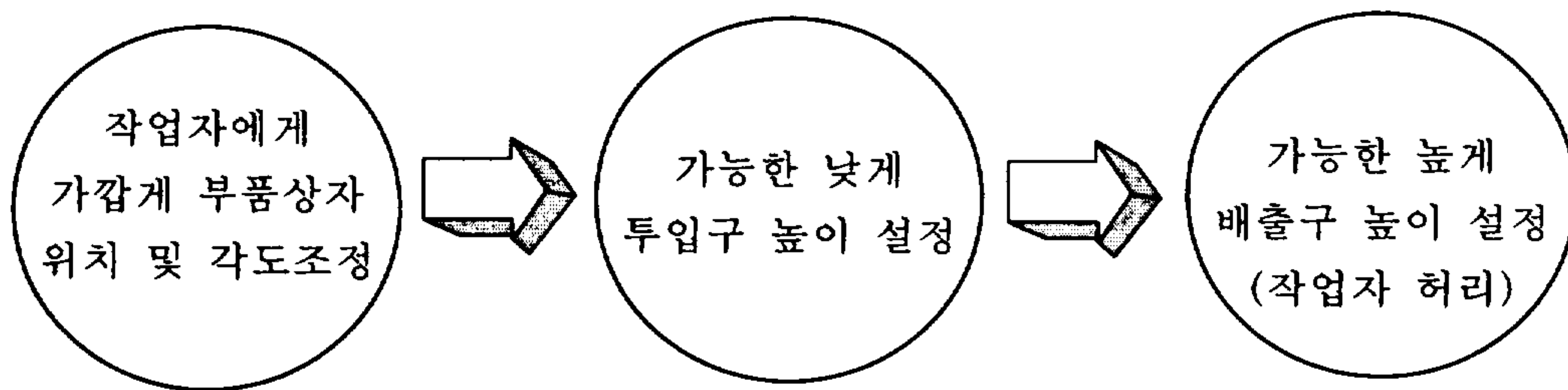
<그림 27> 자재 투입 시스템의 설계 절차
