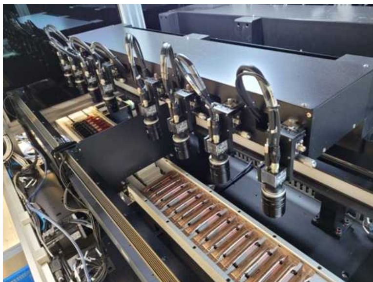
[그림3-19] AI 검사 장비가 제품을 촬영하는 모습
