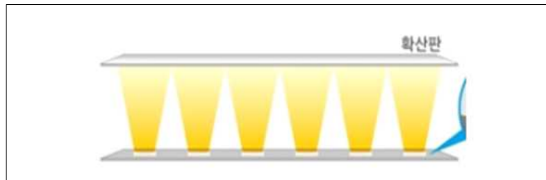
[그림3-17] 광산광(diffused Light) : 확산 판을 통해 빛이 부드럽고 고르게 조사
