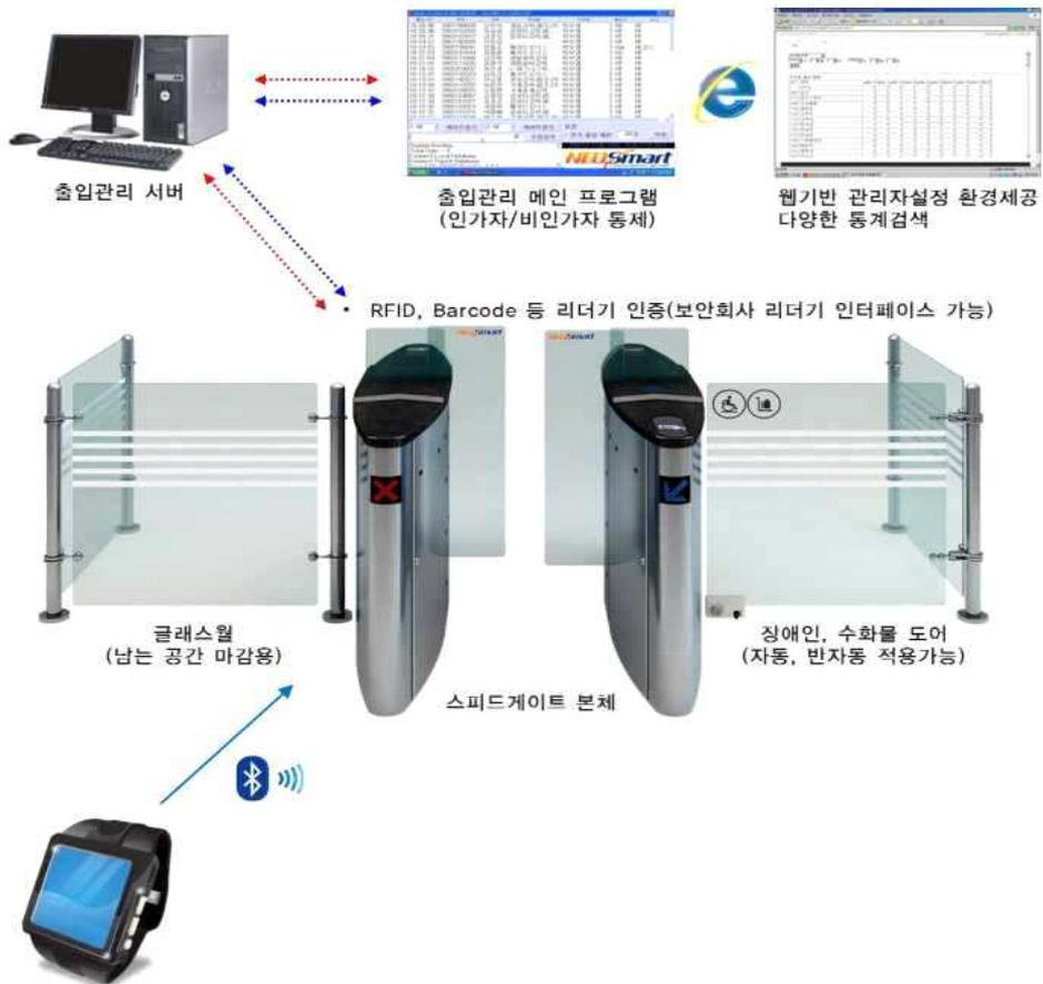
[그림 2-13] 웨어러블 디바이스와 기기 간 통신하는 시스템 구성도
