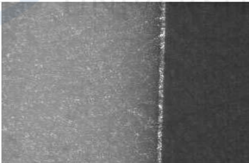
[그림 3-17] 점도에 따른 코팅 결과 (20kcps)
