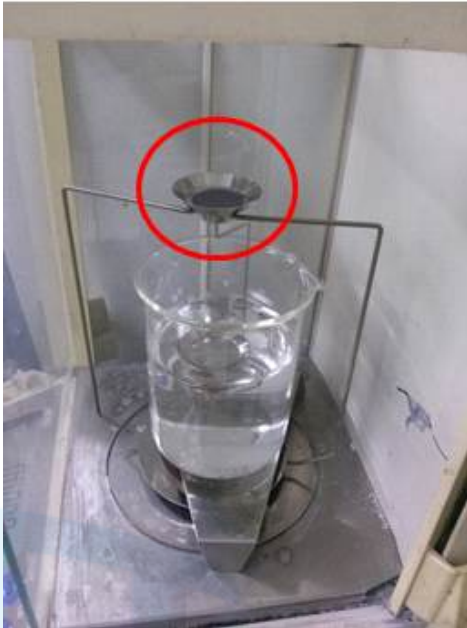
[그림 3-7] 아르키메스 법 측정 장치 및 측정
