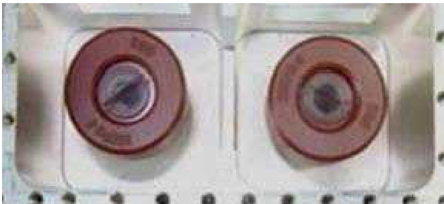
[그림 2-12] 유전체 공진기 필터(Dielectric Resonator Filter)
