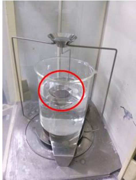
[그림 3-7] 아르키메스 법 측정 장치 및 측정
