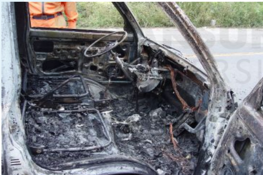
Fig 2.8 운반 중 유증기에 의한 유사휘발유 화재(내부) [3]
