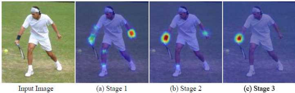
[그림 2-15] Convolutional Pose Machines 구조(S. E. Wei, et al., 2016)
