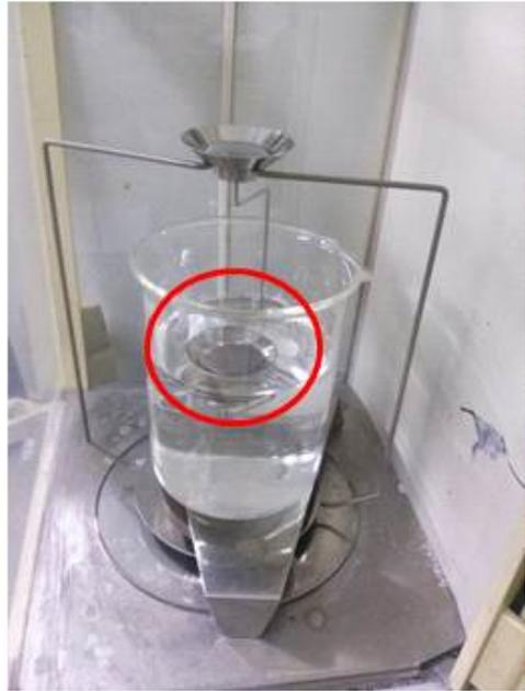
[그림 3-7] 아르키메스 법 측정 장치 및 측정
