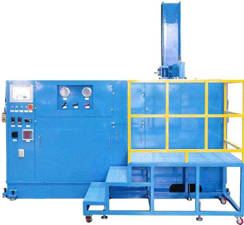
[그림 3-1] 정수압프레스 (Warm Isostatic Press)
