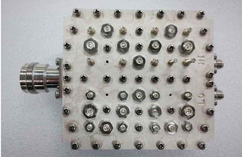
[그림 4-5] 800MHz Duplexer Small Cavity Filter Sample
