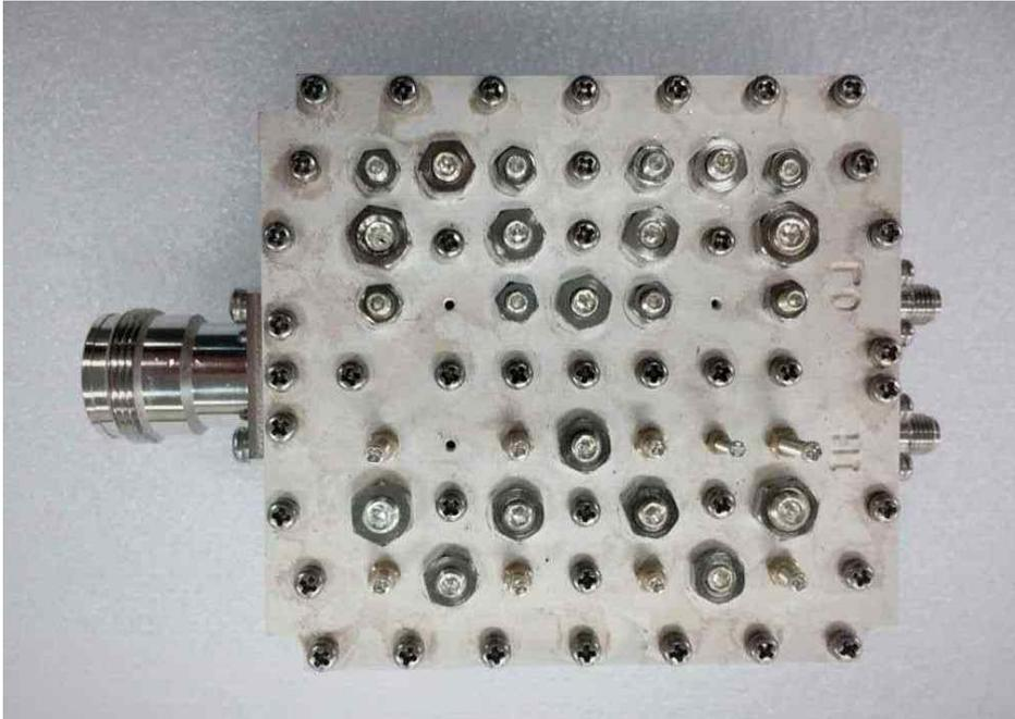
[그림 3-36] 800MHz Duplexer Sample
