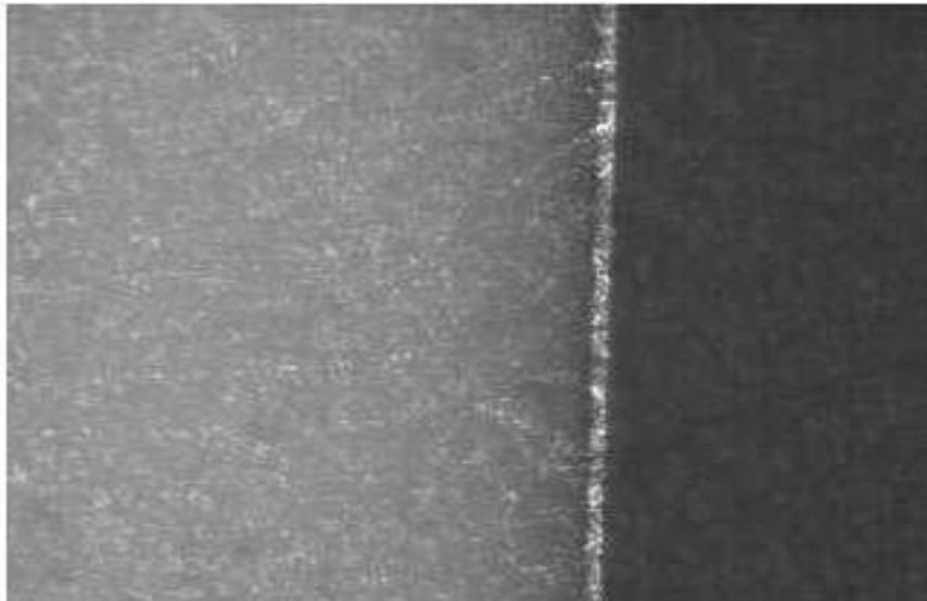
[그림 3-17] 점도에 따른 코팅 결과 (20kcps)
