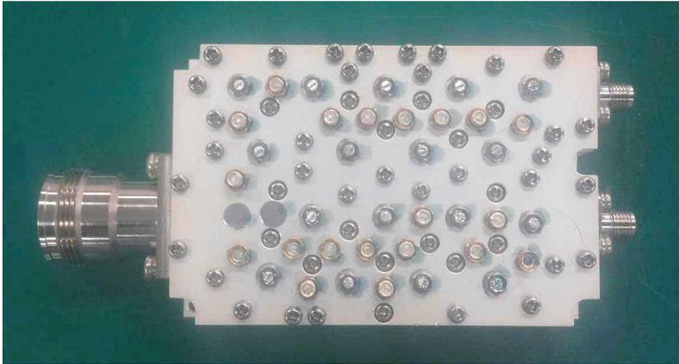
[그림 4-8] 2100MHz Duplexer Small Cavity Filter Sample
