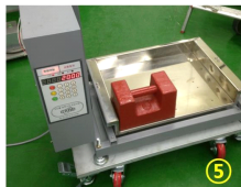
[그림 2-8] 분동을 이용한 편심 시험
