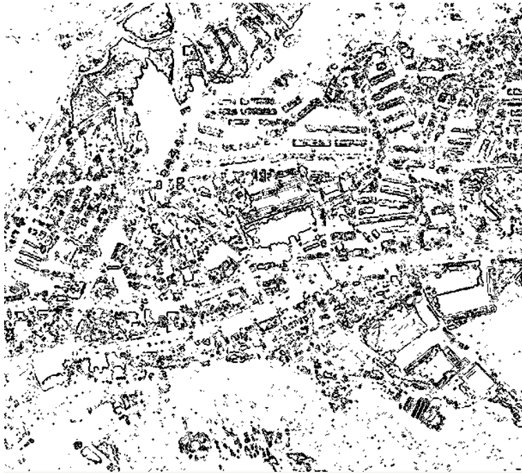
그림 42. 남양주시 영상에 경계치(30~110)를 설정하여 추출한 결과 영상의 역상 전환.
