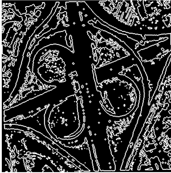
그림 19. 원본 영상의 지형지물의 외곽선을 추출한 결과 영상. 하기 위해 역상 전환한 결과 영상이다.
