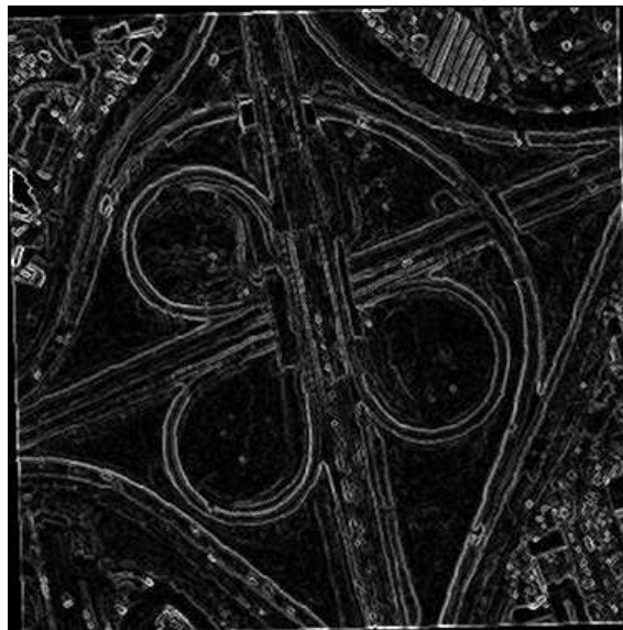
그림 28. 명암 모폴로지 처리 결과 추출한 지형지물의 외곽선 영상.
