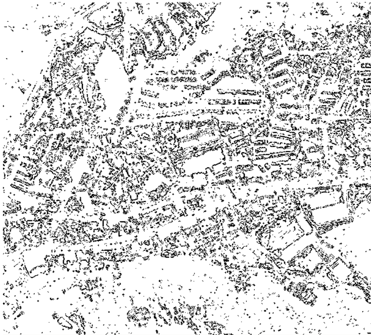
그림 44. 남양주시 영상의 3가지 경계치를 설정하여 추출한 결과 영상의 역상 전환.
