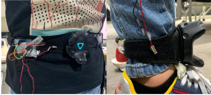
[그림 3-8] 아두이노 및 진동 센서 착용 모습
