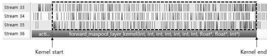
[그림 4-3] NVIDIA Visual Profiler [22]를 사용하여 스트림 H 와 스트림 L 의 커널을 동시에 실행할 때 선점 효과
