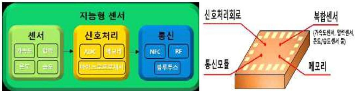
[그림 2-13] 스마트 센서 아키텍처 및 형태
