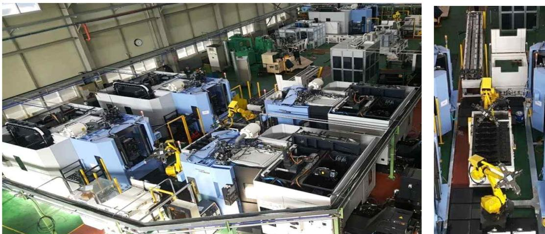
[그림 4-2] 신규 MCT 도입 및 로봇, 이송장치 설치 현황
