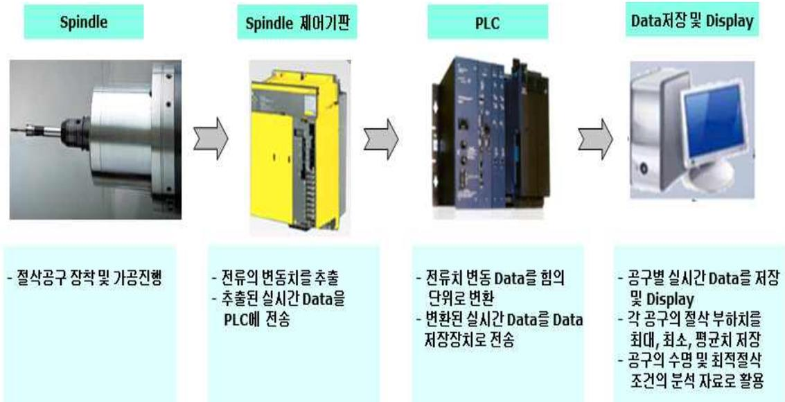
[그림 4-6] 공구 모니터링 및 데이터 추출 시스템
