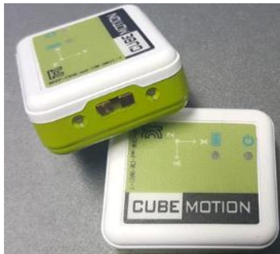
[그림 3-71] IMU 센서
