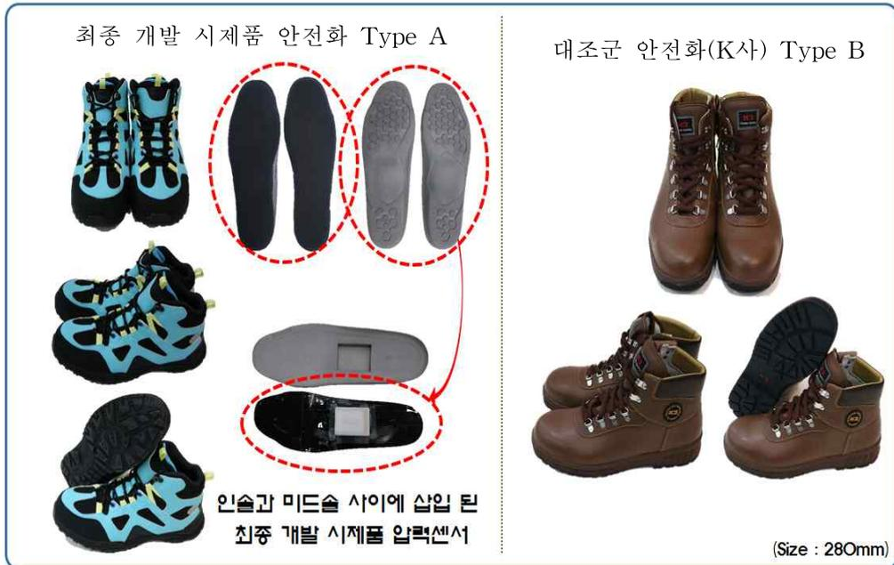
[그림 3-105] 생체역학적 성능평가에 사용된 최종 개발 시제품 안전화 Type A 및 대조군 안전화(K사) Type B
