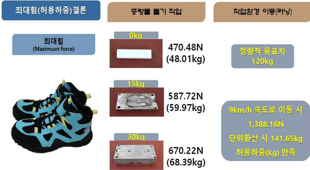
[그림 4-18] 중량물 몰드작업 및 이동(러닝) 최대힘(허용하중) 분석
