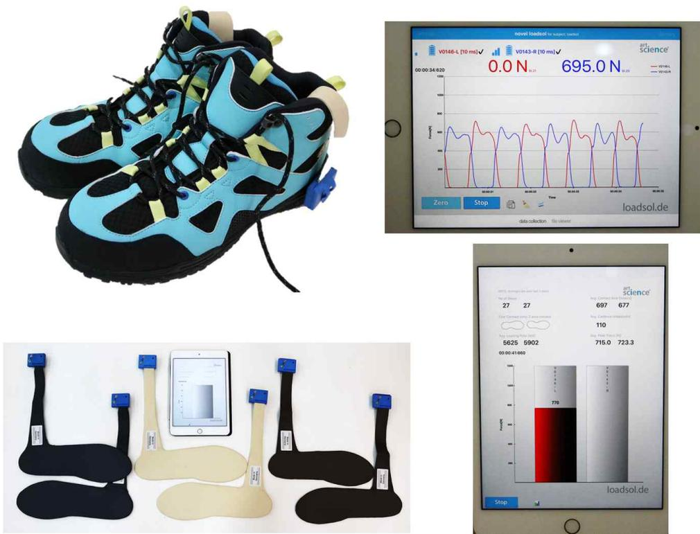
[그림 3-111] 최종 생체역학적 성능평가 loadsol insole 최대힘 측정장비
