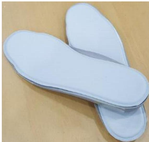
[그림 3-69] 개발된 센서 모듈이 적용된 안전화 인솔
