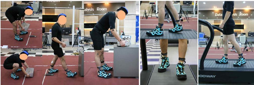
[그림 3-112] 최종 생체역학적 성능평가 loadsol insole 최대힘 측정사진
