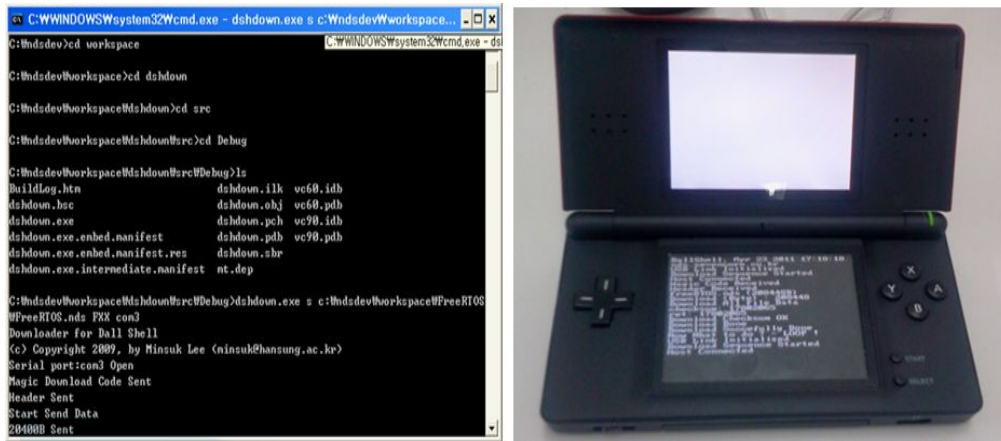
그림 2.19 콘솔 다운로더를 이용한 프로그램 다운로드
