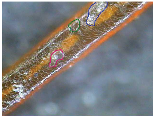
<그림 24 모표피 Scale> Scale의 형태, 박리비를 구하는 사진
