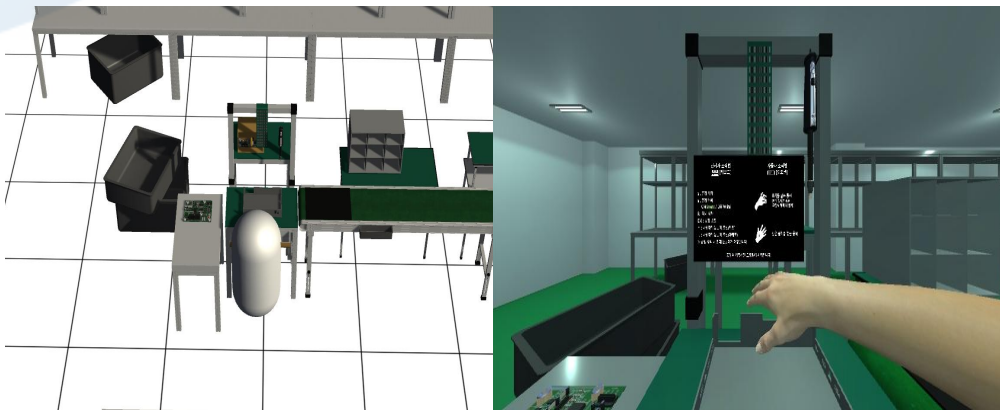
[그림 4-51] 공정 생성 자동화로 VR Test Bed 3D 공간 구축 왼쪽 : 작업 레이아웃 설계에서 작업한 작업 설계 오른쪽 : VR Test Bed에서 작업 설계를 기반으로 생성한 3D 공간
