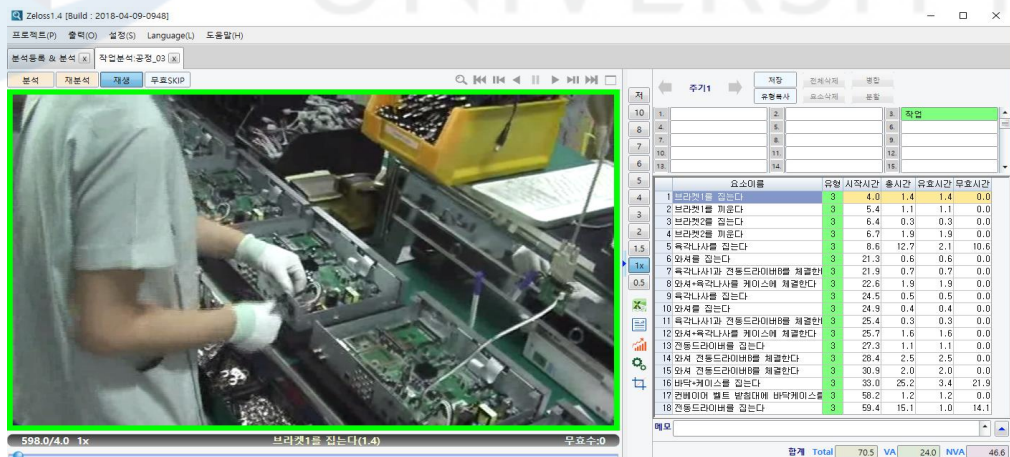
[그림 4-82]와 같이 셋톱박스 조립공정의 세 번째 작업을 동작분석 자동화 시스템에서 분석된 결과 18개의 동작요소로 70.5초의 정미시간을 추출할 수
