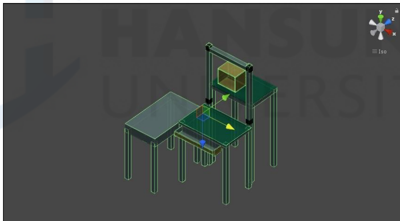
[그림 4-58] 연두색 선으로 표시된 영역이 물리적인 충돌(Collider) 영역
