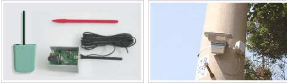
그림 3.3.2 위치비콘 장비와 노변 설치모습
