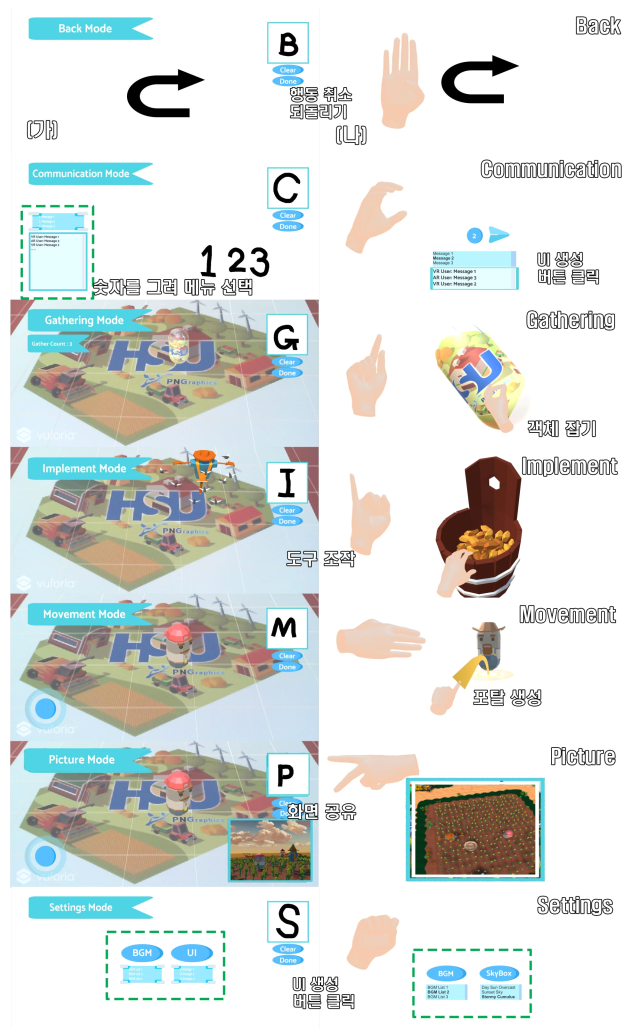
[그림 15] 딥러닝을 활용한 인터페이스를 통해 사용자별로 행동을 수행하는 과정: (가) 가상현실 사용자의 제스처 인터페이스 (나) 증강현실 사용자의 텍스트 인터페이스
