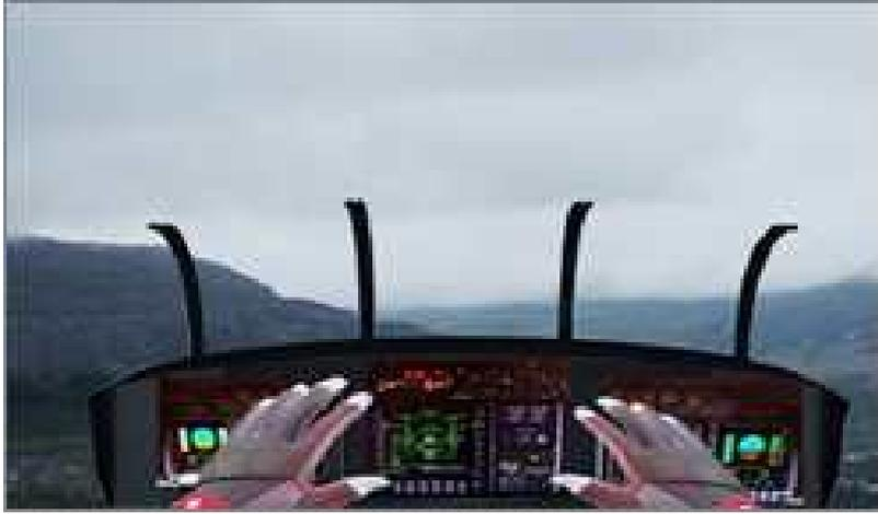
그림 4-3 Haptic Glove로 가상계기 터치 조작
