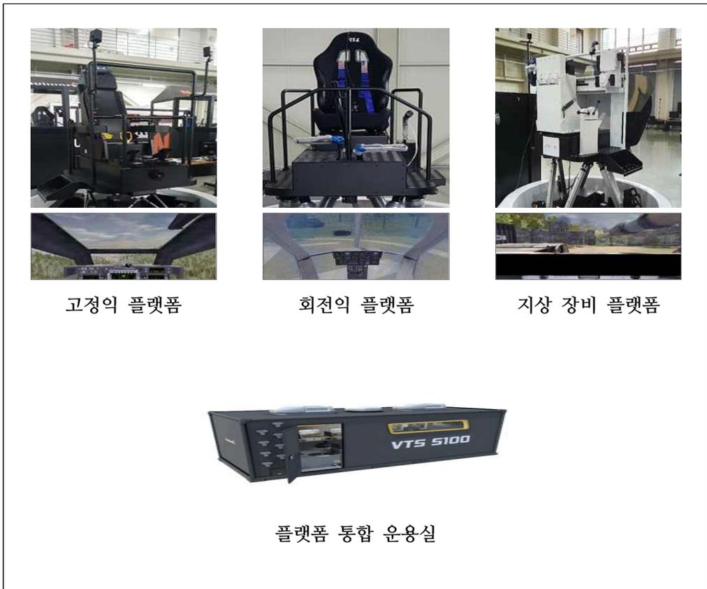
그림 4-1 HMD 기반 다기종 훈련용 시뮬레이터 구성도
