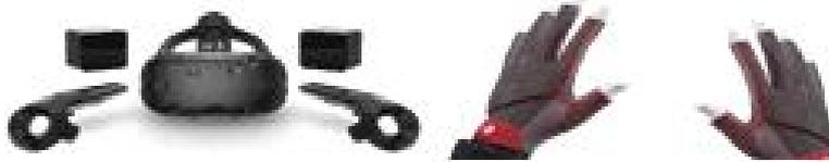
그림 4-4 HMD/센서/컨트롤러, Haptic Glove
