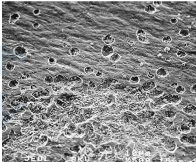
[그림 2-28] 수명 테스트가 끝난 셀 내에서 부식이 진행된 알루미늄 집전체의 표면 SEM 사진.
