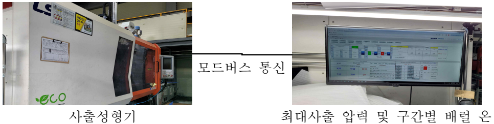
[그림 3-2] 최대사출 압력과 구간별 배럴 온도 수집 방법
