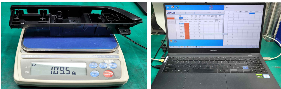
[그림 3-3] 사출품 중량 계량 및 데이터 수집 방법
