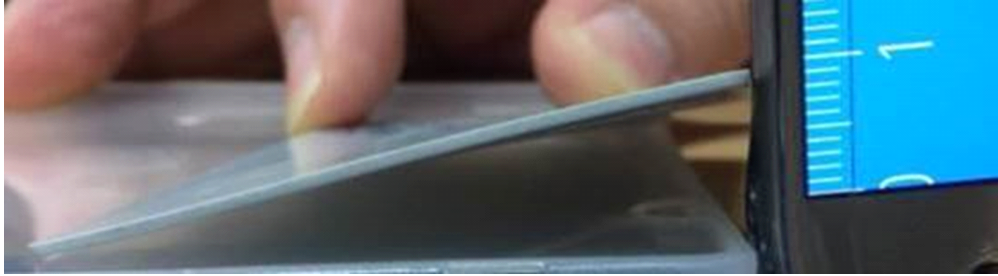
[그림 3-8] 카드 시편 휨 측정 결과
