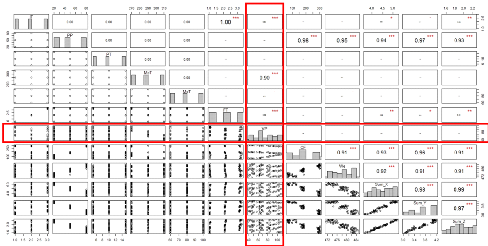
[그림 4-12] 보압 절환 시 사출 압력(VP)의 상관분석 결과
