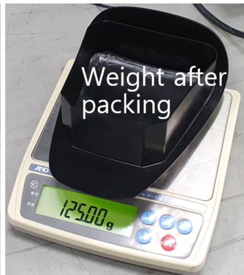
[그림 3-102] 보압 절환 시 제품 중량(좌), 보압적용 후 제품중량(우)
