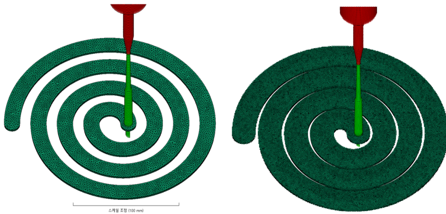
[그림 3-38] 2mm 두께 스파이럴 디자인, 폭 15mm(좌), 폭 23mm(우)
