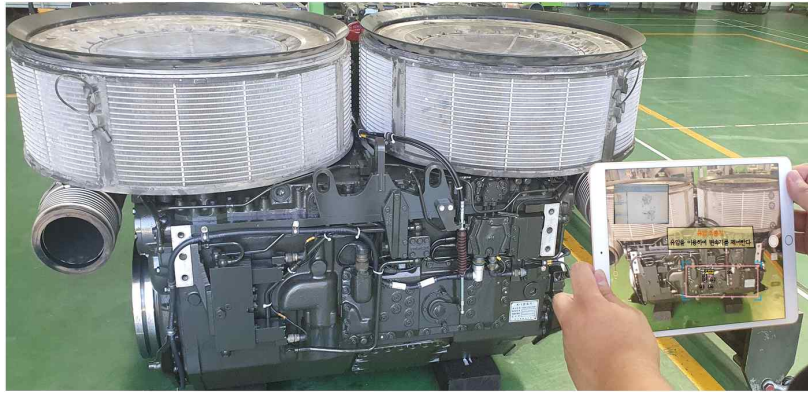
[그림 4 - 1] AR체계를 이용한 파워팩 정비(例)
