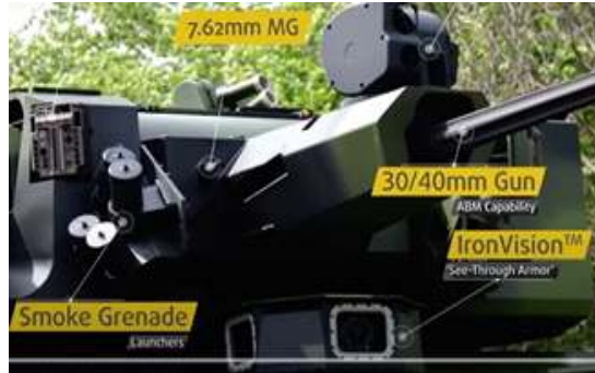
[그림 2 - 6] IRON VISION 설치모습
