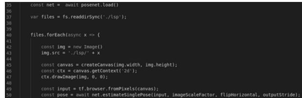
그림 4. PoseNet의 Single-Person Pose Estimation Fig. 4. Single-Person Pose Estimation on PoseNet.
