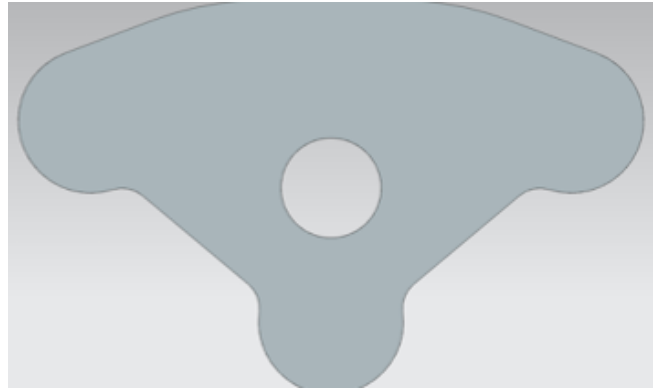
Fig3.15 최종 로커암 Side View
