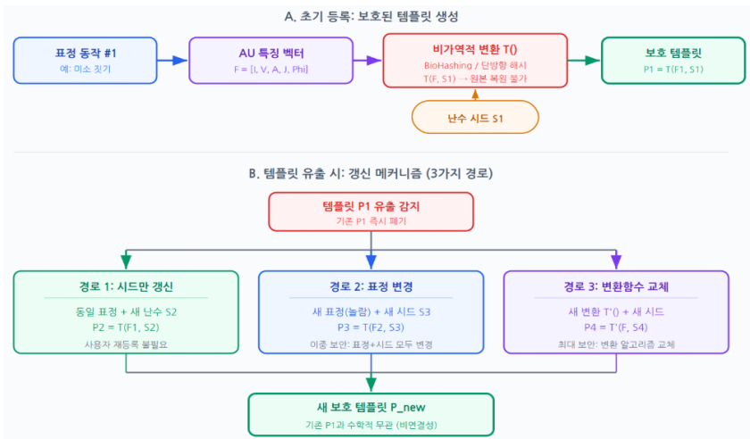
<그림7> 취소 가능 생체인증 템플릿 갱신 메커니즘 및 ISO/IEC 24745 준수 구조 (출처:저자 작성)
