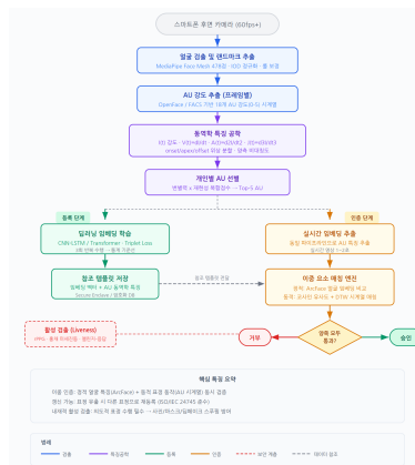
<그림 2> AU 기반 생체인증 시스템 아키텍처 및 데이터 흐름 (출처:저자작성)
